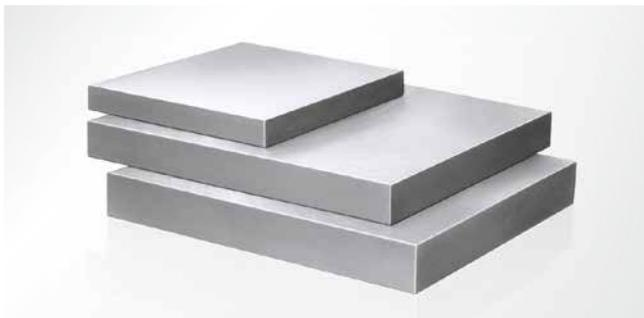
Die Stahlplatten aus Material 1.1730 (C45) werden in unterschiedlichen Größen angeboten. Sie sind spannungsarm gegläht, allseitig bearbeitet und planparallel geschliffen.
